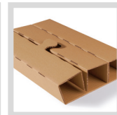
Den flachliegenden Zuschnitt der Innenverpackung von rechts einfallen und dann von links einfallen und mittels Steckflasche in der vorgestanzten Öffnung fixieren.
