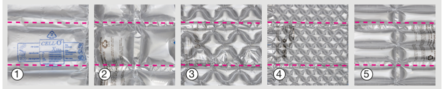
Universeller Einsatz – fünf verschiedene Polsterkissentypen hergestellt auf der FP-MINI PAK 'R (gestrichelte Linie = Kissenerforation)
